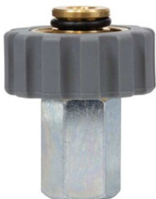
Vysokotlaké šroubení 1/4"F s převlečnou maticí M21x1,5F (400 bar)
