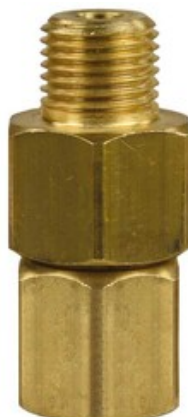
Otočné šroubení ST-300 pro vysokotlaké pistole 1/4"M-1/4"F (275bar)
