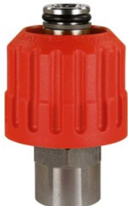
Vysokotlaké šroubení 3/8"F s převlečnou maticí M24x1,5F (700 bar)
