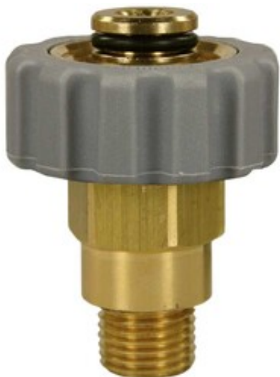
Vysokotlaké šroubení 1/4" M s převlečnou maticí M21x1,5F (400 bar)
