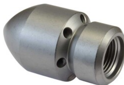
Vysokotlaká kanalizační tryska Granát 30° 500bar 3/8" 6+1 (200)
