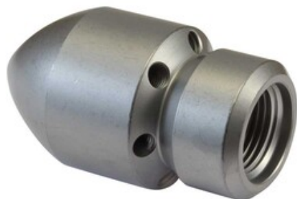
Vysokotlaká kanalizační tryska Granát 30° 500bar 3/8" 6+1 (060)
