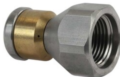
Vysokotlaká rotační kanalizační tryska 250bar 3/8" ST-49.1 (100)
