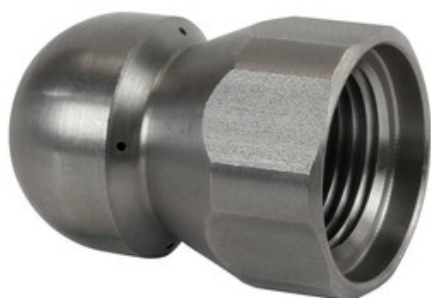
Vysokotlaká kanalizační tryska 250bar 3/8" ST-49 4+1 (150)
