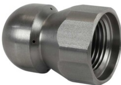
Vysokotlaká kanalizační tryska 250bar 3/8" ST-49 4+1 (100)
