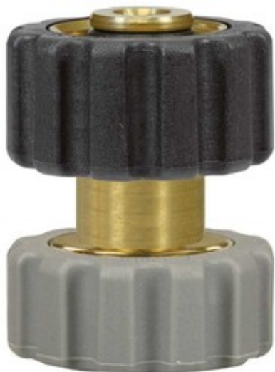
Oboustranné vysokotlaké šroubení s převlečnou maticí M22x1,5F - M21x1,5F (400 bar)
