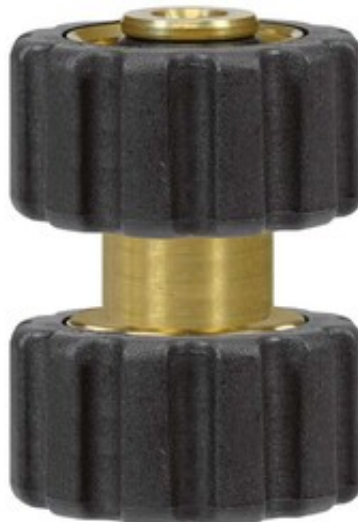
Oboustranné vysokotlaké šroubení s převlečnou maticí M22x1,5F - M22x1,5F (400 bar)
