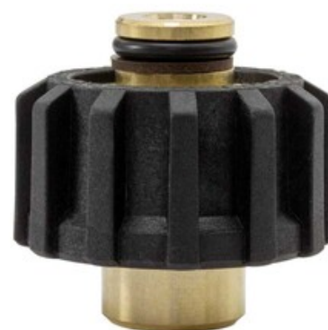
Vysokotlaké šroubení 1/4"F s převlečnou maticí M22x1,5F (400 bar)
