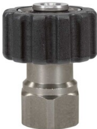
Vysokotlaké šroubení 3/8"F s převlečnou maticí M22x1,5F (500 bar)
