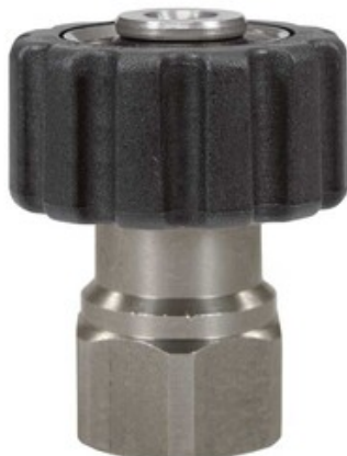
Vysokotlaké šroubení 3/8"F s převlečnou maticí M22x1,5F (500 bar)
