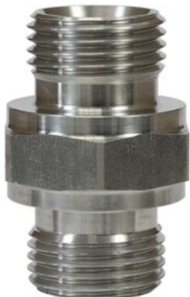
Oboustranné šroubení 1/8" M - 1/8" M nerez (500bar)
