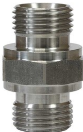
Oboustranné šroubení 1/4" M - 1/4" M nerez (500bar)
