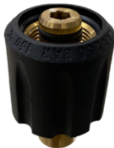
Vysokotlaké šroubení 3/8"M s převlečnou maticí M22x1,5F Mazzoni
